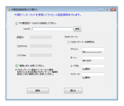
この画面上の「認証 ID」、「プロダクト ID」、「シリアル No.」は、代理認証解除データの取得メソッド (APIGetProxyDataForRemove メソッド)の実行で設定される認証 ID プロパティ(APICertificationID プロパティ)、プロダクト ID プロパティ(APIProductID プロパティ)、シリアル No.プロパティ (APISerialNo プロパティ)でそれぞれ取得できます。
