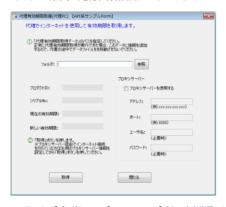
この画面上の「プロダクト ID」、「シリアル No.」、「現在の有効期限」は、代理有効期限取得データの取得メソッド(APIGetProxyDataForExpirationDate メソッド)の実行で設定されるプロダクト ID プロパティ(APIProductID プロパティ)、シリアル No.プロパティ(APISerialNo プロパティ)、現在の有効期限プロパティ(APICurrentExpirationDate プロパティ)で取得できます。
